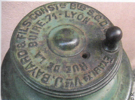
Le volant et son trou de graissage du roulement à bille (sans la vis d'obturation)
